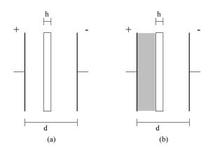
Tra le armature di un condensatore a facce piane parallele carico con una carica Q, di superficie S e distanti d che ha come dielettrico il vuoto, viene inserita una lastra piana conduttrice di spessore h < d con la stessa forma e superficie delle armature del condensatore, figura (a). Si chiede di determinare:
